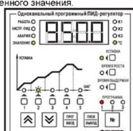
17 Для задания времени выхода на уставку на втором шаге нажмите кнопку **ВРЕМЯ РОСТА**, при этом светодиод «УСТАВКА» погаснет, загорится светодиод «ВРЕМЯ РОСТА». На цифровом индикаторе отобразится значение текущей уставки времени за которое прибор выйдет на заданную температуру при регулировании.
